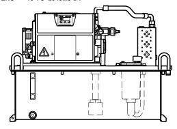
Le centraline ibride ECORICH sono progettate e prodotte da Daikin Industries, LTD. unendo la tecnologia idraulica con un motore sincrono interno a magneti permanenti.
